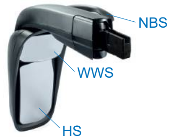
Spiegel mit HS, WWS und NBS (rechts) mirror with HS, WWS and NBS (right)
